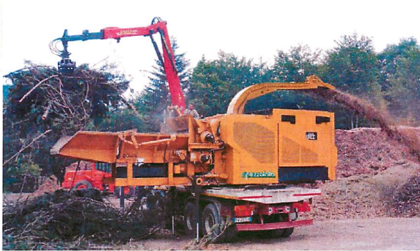
Foto 4.5. Maquinaria astilladora de restos forestales.
